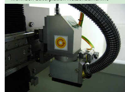
Disk-Trennmodul mit Vision-System
